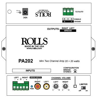
**WARNING:** THE MINIMUM SPEAKER IMPEDANCE FOR STEREO (2 CHANNEL OPERATION) IS 4 OHMS EACH.
